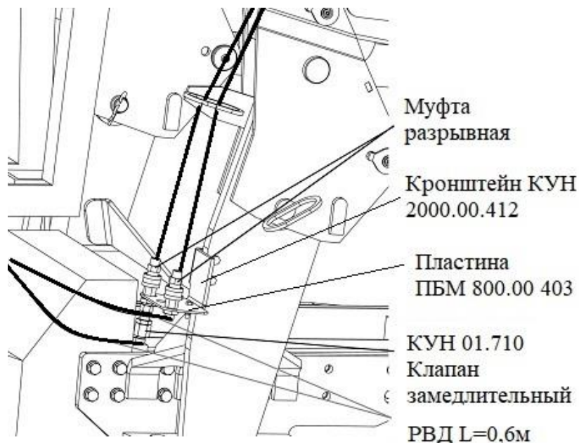
Рисунок 20 – Подсоединение гидросистемы порузчика к гидросистеме трактора
